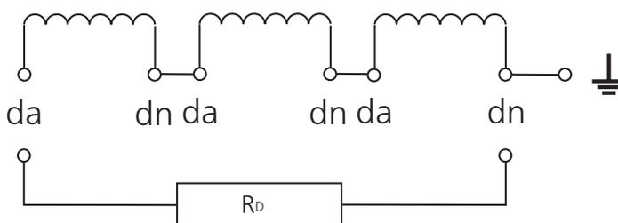
Atención: Hay que asegurar que un sólo punto está puesto a tierra en conexiones en triángulo abierto para evitar un cortocircuito secundario.
