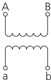
Esquema de un transformador de tensión de dos polos aislado
